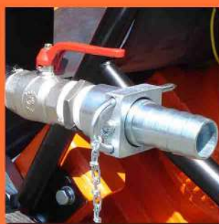
Přívod vzduchu DN40
